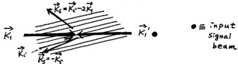
$$P_B^{(3)}(\vec{K}_1 - \vec{K}'_1 + \vec{K}_i, \omega) = \chi^{(3)}(\omega) : E_1(\vec{K}_1) E_1^*(\vec{K}'_1) E_i(\vec{K}_i)$$
