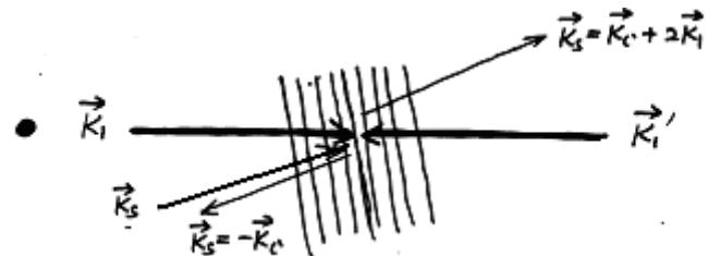
$$P_C^{(3)}(-\vec{K}_1 + \vec{K}'_1 - \vec{K}_i, \omega) = \chi^{(3)}(\omega) : E_1^*(\vec{K}_1) E_1'(\vec{K}'_1) E_i(\vec{K}_i)$$
